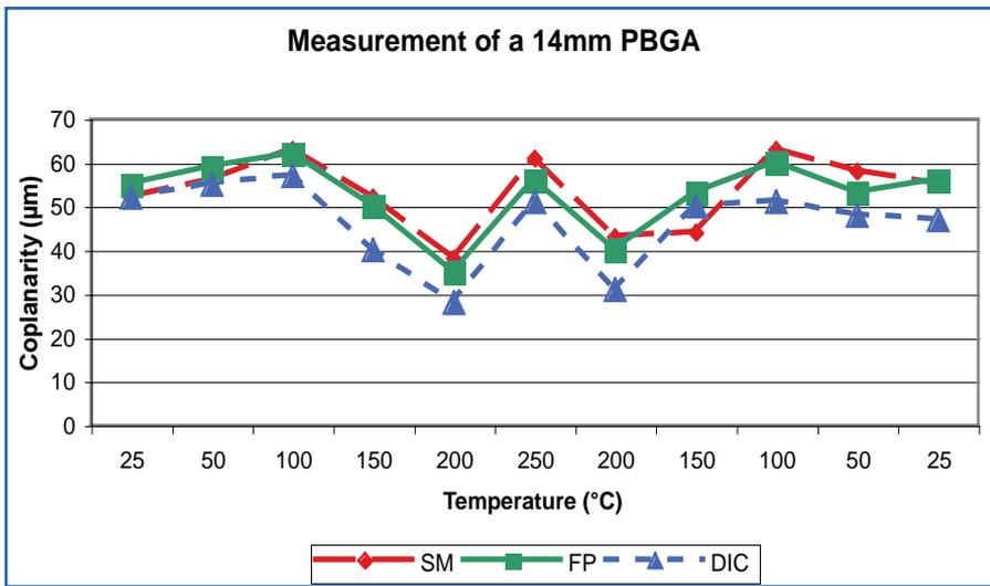
Figure 6a. Thermal warpage of a 14\_14 mm PBGA
